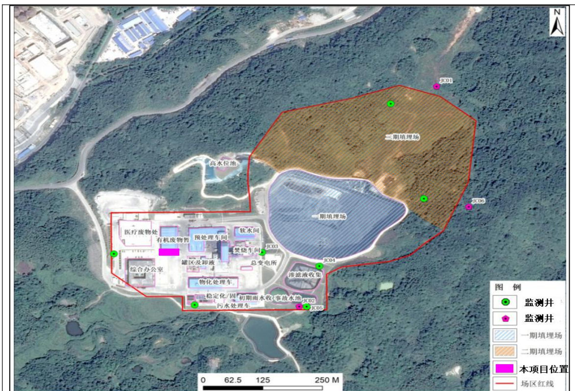
图 7-1 长沙危险废物处置中心地下水监测井布置
